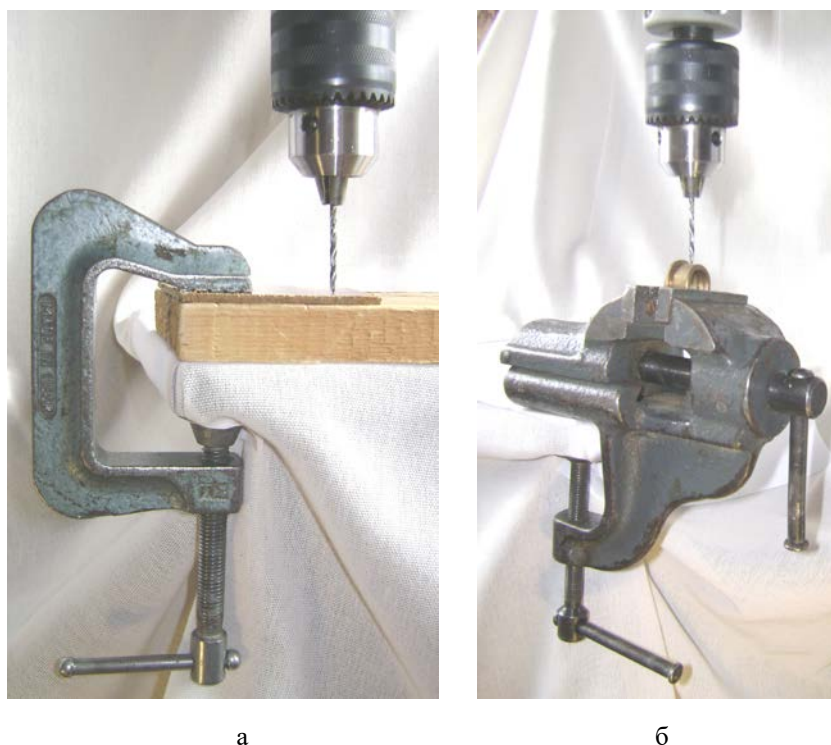
Рисунок 1.1 а, б. Сверление отверстия с применением бытовой дрели: а – фиксация заготовки в струбцине; б – фиксация заготовки в тисках
